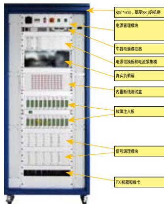
图2.2 HIL测试系统硬件平台示意图
