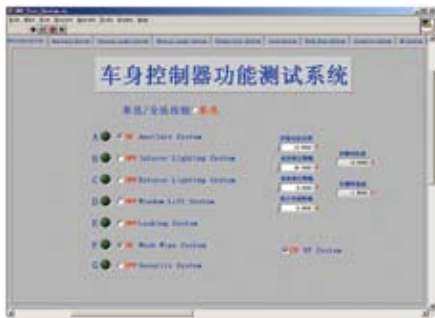
图4 车身控制器功能测试系统电源设置及分系统选择界面
