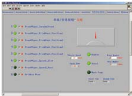
图5 车身控制器功能测试系统测试项选择、参数设置显示界面
