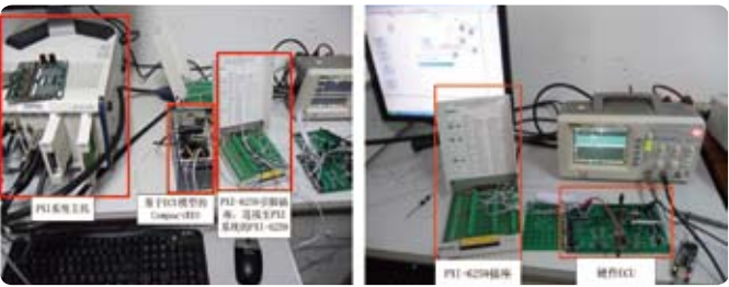
（a）ECU快速原型 （b）真实ECU在环仿真
