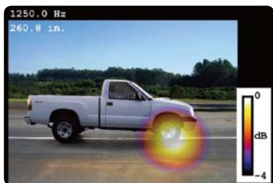
声学图像识别50公里时速、1,904.3 Hz下的轮胎和排气噪声
