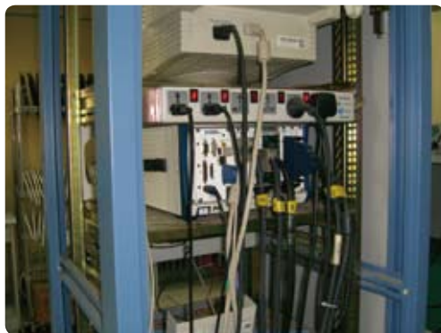
图6 19寸控制柜中的PXI控制器及NI板卡
