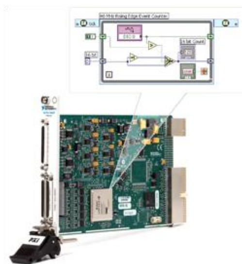
图 1， 使用 LabVIEW FPGA 模块，用户可以使用熟悉的 LabVIEW 代码对仪器硬件进行自定义。对于射频应用，用户可以以预创建的范例项目为基础，添加相应修改以实现自定义触发，待测设备控制，信号处理等功能。
