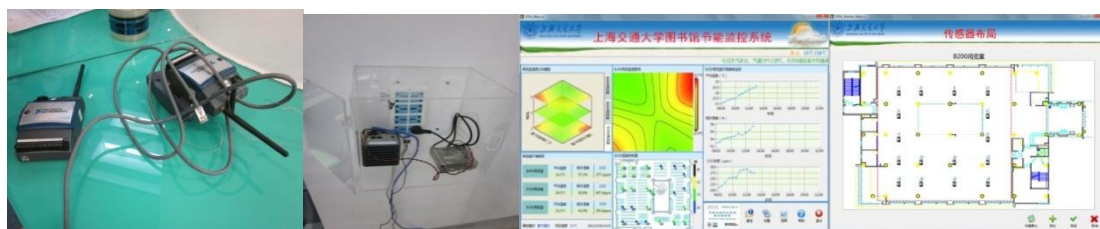
图 1 现场 WSN 无线节点 图 2 现场 NI9792 无线网关 图 3 系统主界面 图 4 传感器布局界面图
