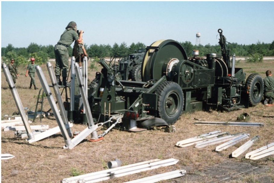
图2：单个飞机拦阻 制动系统
