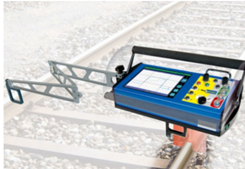
图5. 使用非触电 涡流传感器绘制出纵 剖面图，并用磁编码 器 脉冲调制
