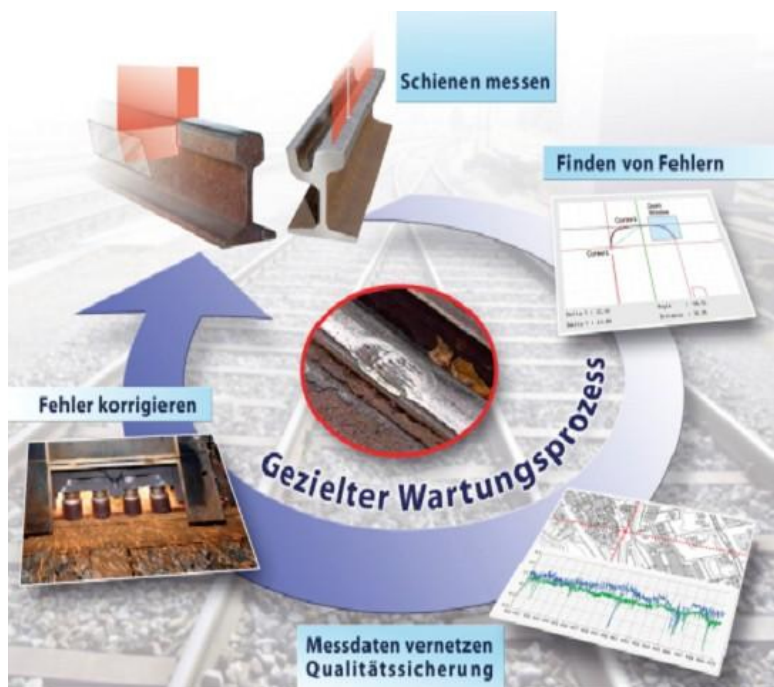
图1. 一个系统的 铁轨维护理念包含测 量，定位，规划以及 维修铁轨故障
