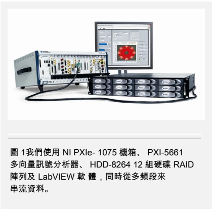
圖 1我們使用 NI PXIe- 1075 機箱、PXI-5661 多向量訊號分析器、HDD-8264 12 組硬碟 RAID 陣列及 LabVIEW 軟體，同時從多頻段來串流資料。
